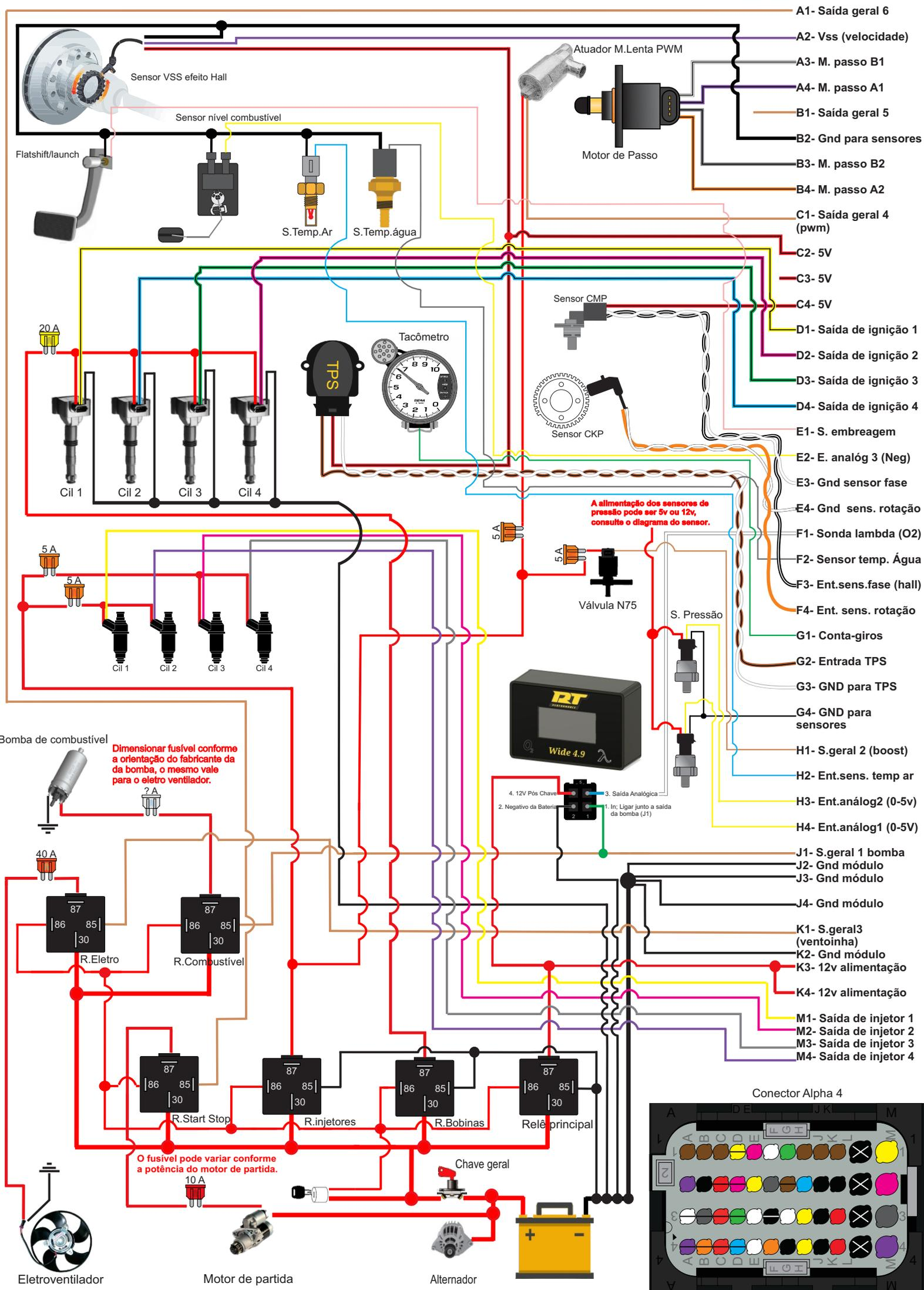
Dimensionar fusível conforme a orientação do fabricante da bomba, o mesmo vale para o eletro ventilador.
